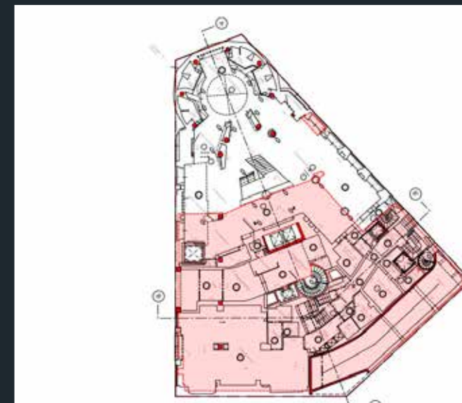
Nouveau plan de démolition du rez-de-chaussée montrant la conservation de l'escalier, juin 2025 (© Gensler).
