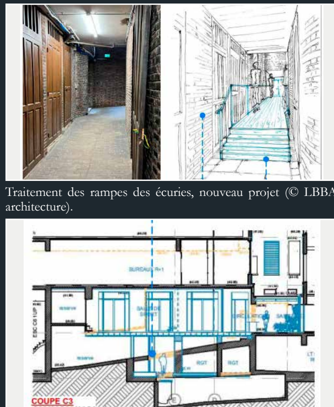
Rampe du 155 boulevard Haussmann toujours en partie détruite pour faciliter les circulations en sous-sol, nouveau projet (© LBBA architecture).
